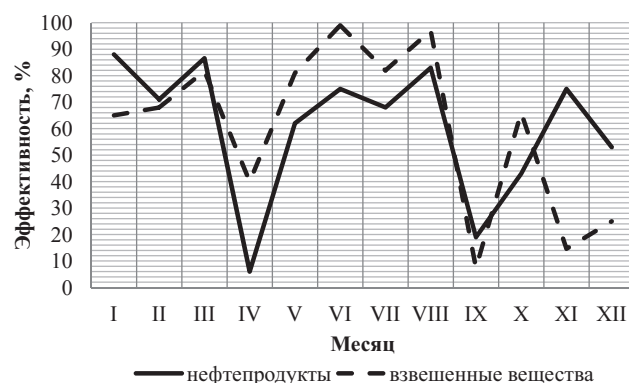
Рис. 3. Изменение эффективности работы очистных сооружений в разрезе года, выраженной, в %
