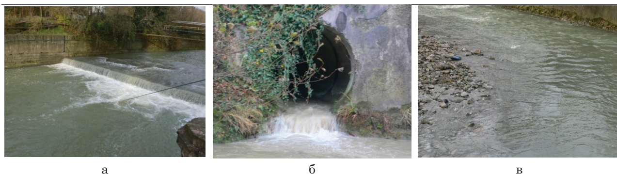
Рис. 5. Реперные точки отбора проб воды в реке Мацеста а – точка отбора проб воды выше створа сброса поверхностных вод; б – точка отбора проб воды в створе сброса поверхностных вод с территории строительной площадки; в-точка отбора проб ниже створа сброса поверхностных вод с территории строительной площадки
