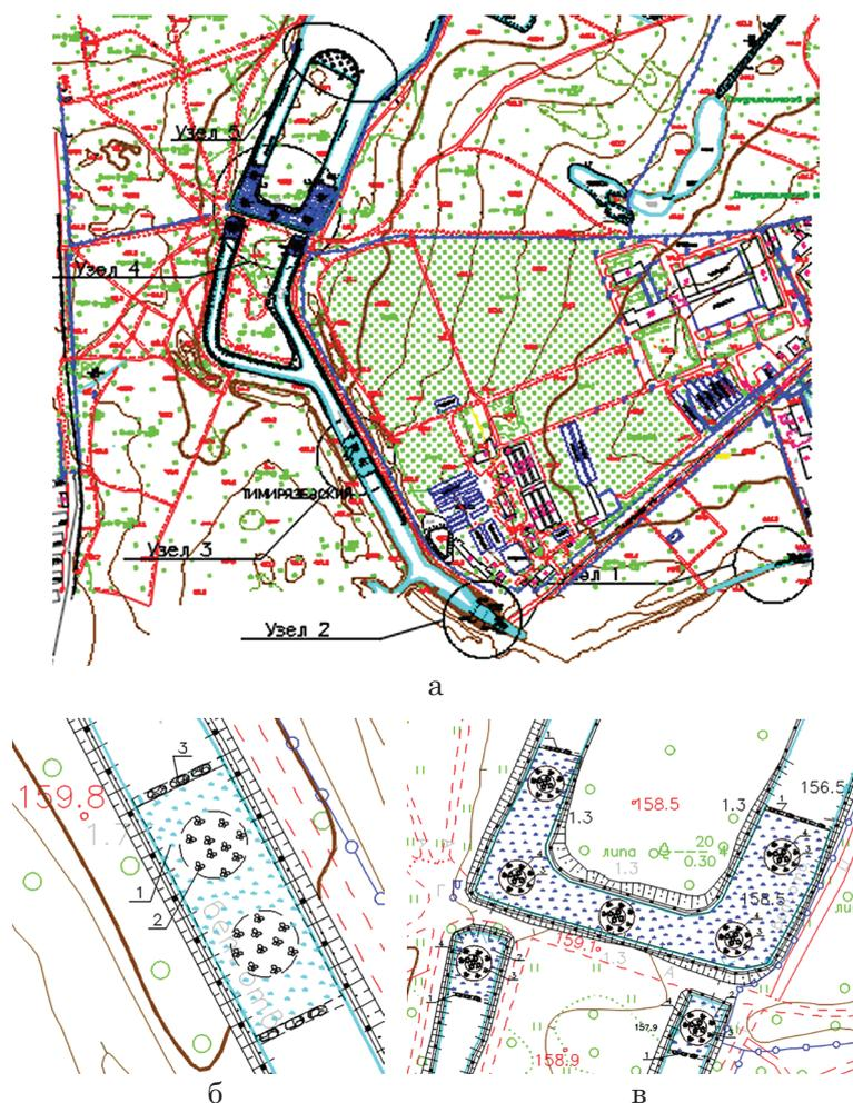
Рис. 3. Схема системы естественной биологической очистки р. Жабенка в месте её впадения в Большой Садовый пруд с использованием высшей водной растительности, состоящее из 5 узлов (а);
