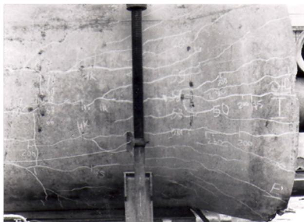
Рис. 8. Трещины на наружной поверхности трубы в опытах
