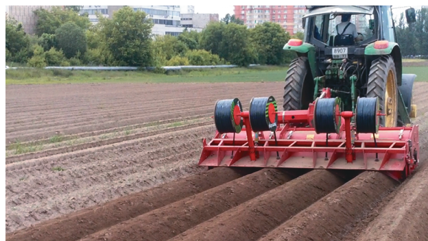
Рис. 2. Испытания укладчика капельной ленты на базе гребнеобразователя Grimme GF-75/4
