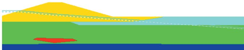
Рис. 4. Результаты ввода грунтов для первого расчетного случая в расчетном сечении ограждающей плотины Краснодарского водохранилища в долине р. Псекупс
