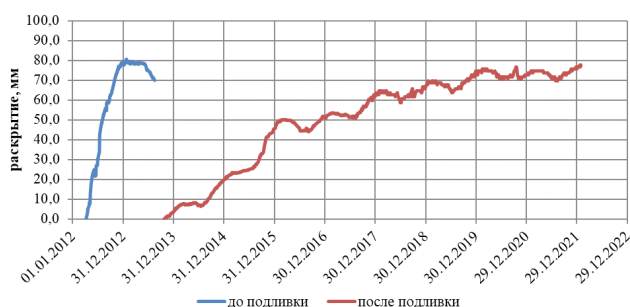
Рис. 3. Ширина раскрытия контактного шва между АБД и секцией № 34, мм
