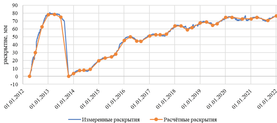
Рис. 8. Сопоставление расчетных и измеренных значений ширины раскрытия контактного шва между АБД и секцией № 34 после перемонтажа штатива и подливки асфальтовой мастики в шахту
