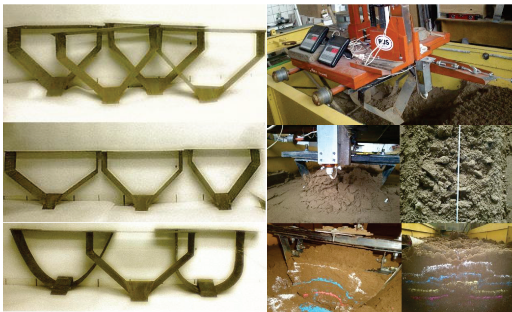
Рис. 1. Модели объемного мелиоративного рыхлителя (слева). Фрагменты проведения лабораторных исследований на грунтовом канале (справа) Fig. 1. Models of a volumetric reclamation ripper (left). Fragments of laboratory research on a soil channel (right)
