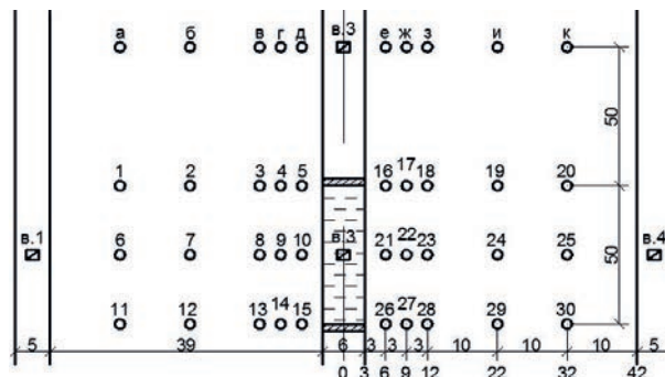
Рис. 1. Схема расположения скважин: а...к, 1...30 –скважины; в.1...в.4 – водомерные посты; шлюз в створе в.3–в.3
