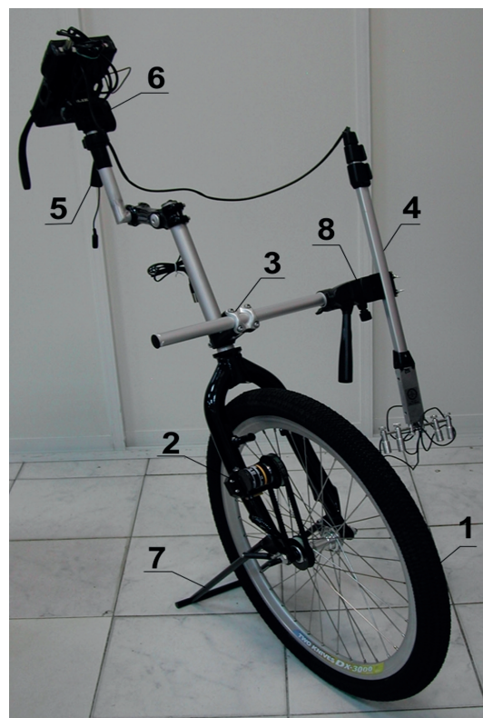
Рис. 1. Сканирующий приборный комплекс для БМД: 1 – дорожное колесо; 2 – узел счета длины; 3 – узел крепления датчика Тип 11; 4 – датчик Тип 11; 5 – ручка; 6 – узел крепления измерительного прибора; 7 – складная опорная стойка; 8 – универсальная головка
