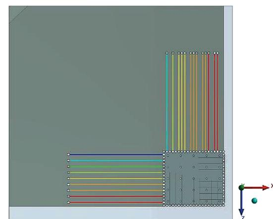
Рис. 8. Этап 2. Вид сверху. Напряжения в анкерных тягах, МПа
