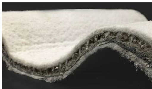
Рис. 2. Структура (а) и общий вид (б) бетонного полотна марки BeNotex SK
