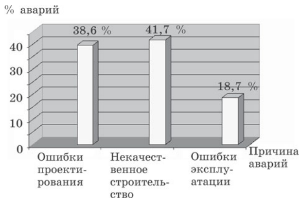
Рис. 1. Распределение аварий грунтовых плотин мира ( H > 30 м) после 1950 года, вызванных ошибками проектирования, строительства и эксплуатации
