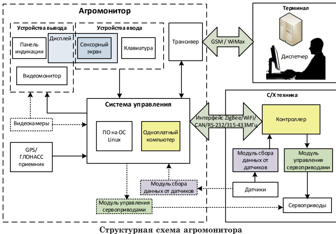
Структурная схема агромонитора
