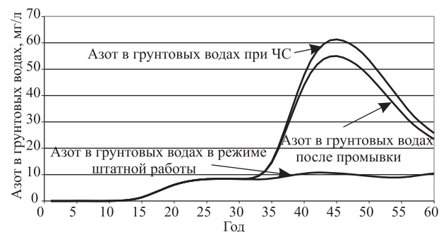
Рис. 6. Азот в инфильтрационных водах после чрезвычайной ситуации и после промывки почвы
