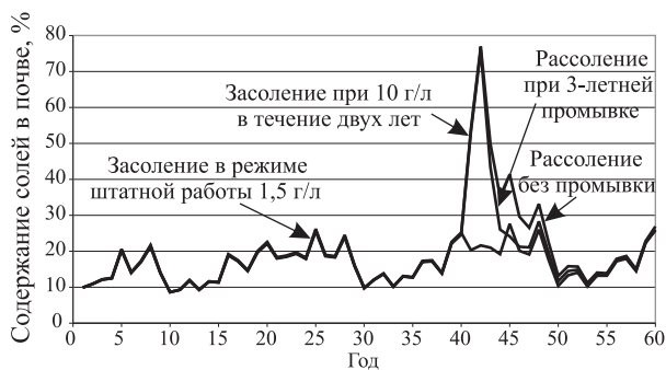
Рис. 8. Влияние скачка минерализации поливной воды и последующей промывки на степень засоленности почвы
