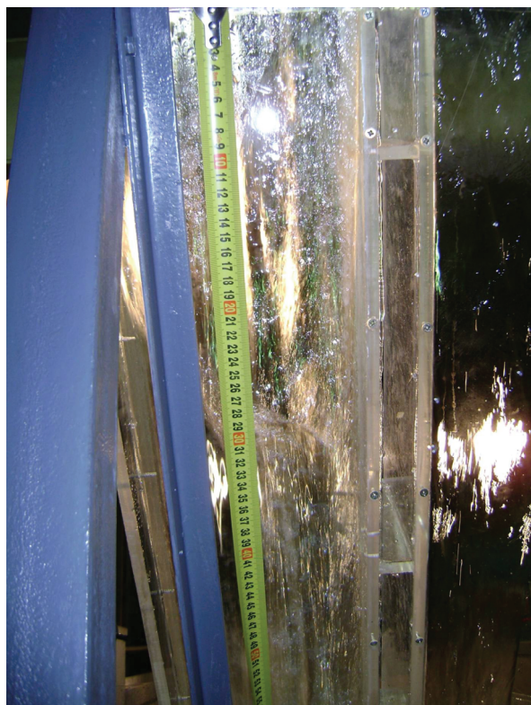
Рис. 2. Вид на нижнюю поверхность потока в пролёте № 1 при УВБ = НПУ = 208,0 \text{ м} и свободном переливе
