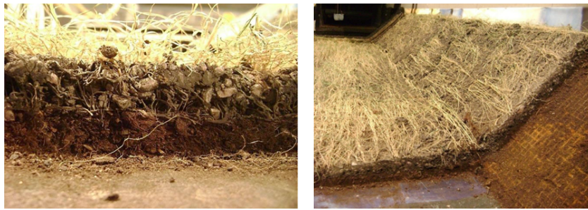
Рис. 8. Состояние покрытия из геомата марки Энкамат А20 с травяным покровом по растительному грунту после проведения серии исследованных гидравлических режимов в экспериментальном лотке
