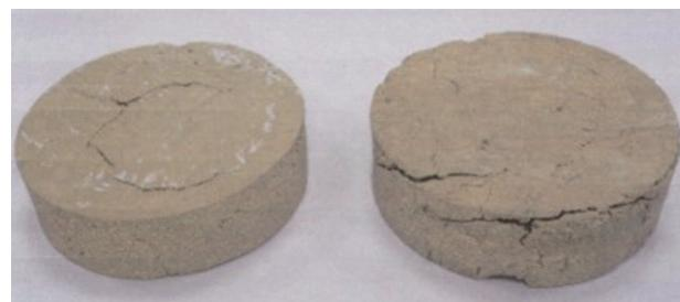
Рис. 4. Образцы глины нарушенной (а) и ненарушенной (б) структуры после высушивания в термостате (на поверхности образца «а» остались следы фильтровальной бумаги в виде светлых пятен)
