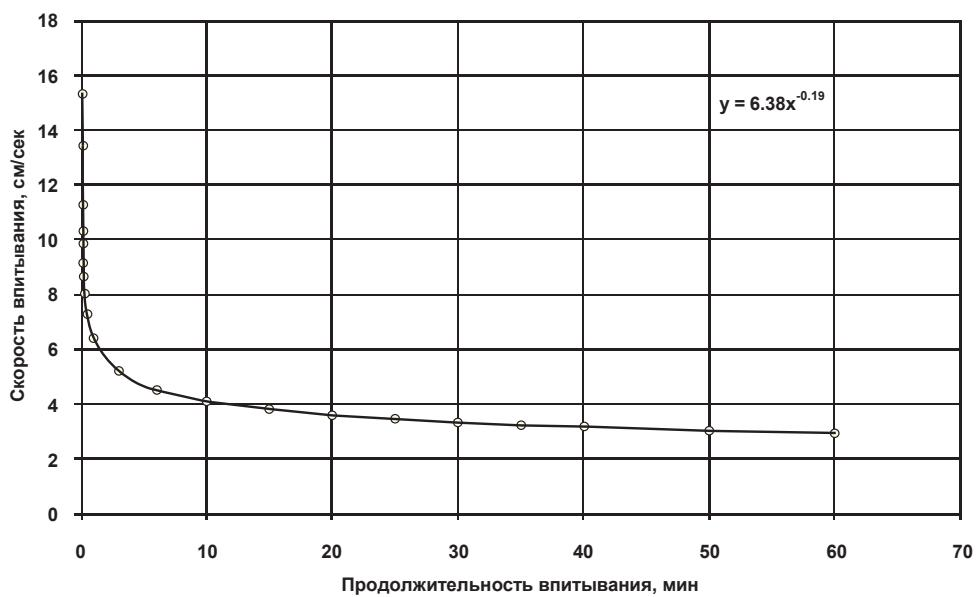
Рис. 1. График скорости впитывания керосина
