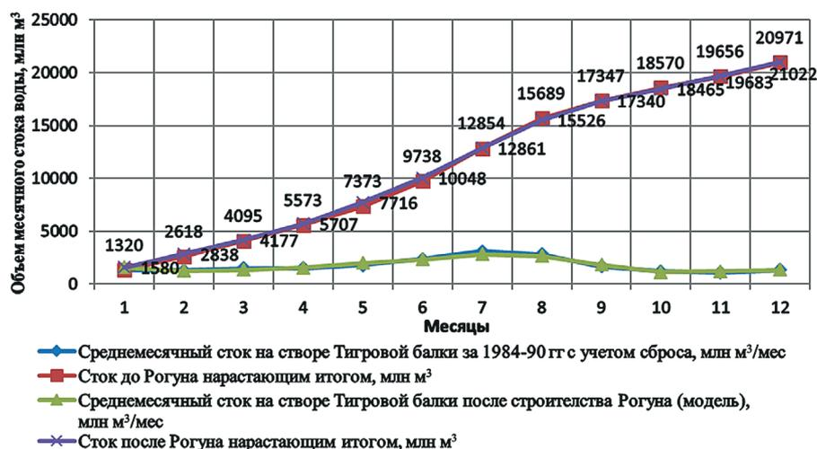
Рис. 4. Сопоставление месячных и годовых стоков реки Вахш в створе Тигровой Балки до и после строительства Рогунского водохранилища
