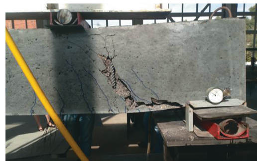
Рис. 5. Характер разрушения железобетонной балки ( \mu = 0,036 ) Fig. 5. Mode of destruction of the reinforced concrete beam ( \mu = 0.036 )
