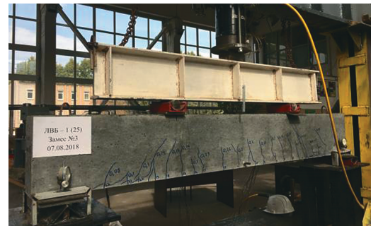
Рис. 4. Испытание железобетонной балки ( \mu = 0,036 ) на стадии трещинообразования Fig. 4. Testing of a reinforced concrete beam ( \mu = 0.036 ) at the stage of cracking
