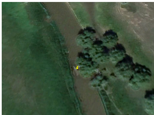
Рис. 2. Образование препятствий движению воды в русле канала Fig. 2. The formation of obstacles in the canal bed that hinder the flow of water
