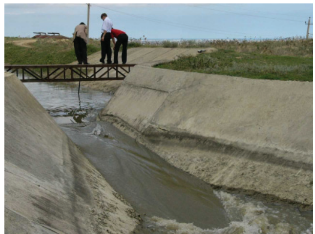
Рис. 3. Опытный образец гидрометрического лотка критической глубины на канале КОР в Дагестане
