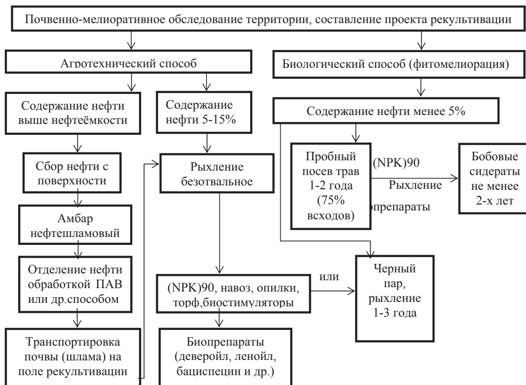
Рис. 2. Схема основных мероприятий по рекультивации нефтезагрязнённых земель [4]
