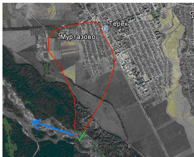
Рис. 3. Схема г.п. Терек и с.п. Интернациональное (Муртазово): красная линия – граница зоны затопления; зеленая линия – заложенный морфоствор; синяя линия – направление течения р. Терек
