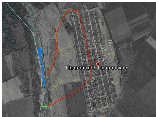
Рис. 1. Схема с.п. Плановское: красная линия – граница зоны затопления; зеленая линия – заложенный морфоствор; синяя линия – направление течения р. Терек
