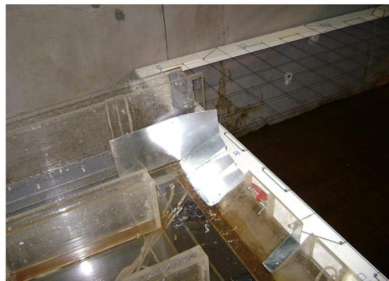
Рис. 3. Ступенчатый отклонитель струи пролета № 1
