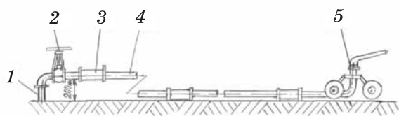
Рис. 6. Общий вид комплекта: 1 — гидрант оросительной сети; 2 — узел подсоединения трубопровода диаметром 110 мм к гидранту; 3 — муфта диаметром 110 мм; 4 — полиэтиленовая труба диаметром 110 мм и длиной 6 м; 5 — тележка с дождевальным аппаратом
