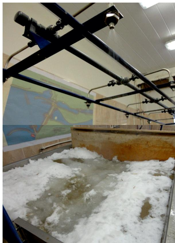
Рис. 2. Дождевальная установка (лаборатория РУДН)
