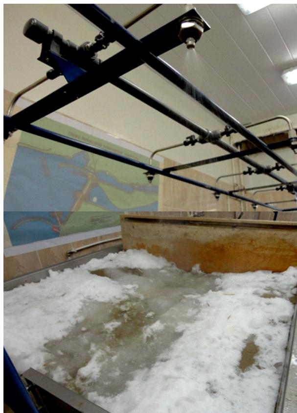
Рис. 2. Дождевальная установка (лаборатория РУДН)
