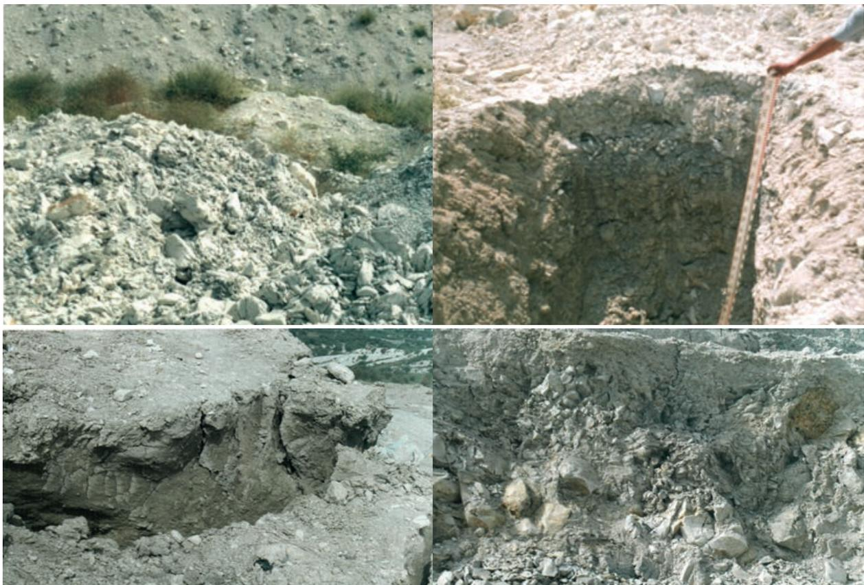
Рис. 1. Продукты разрушения мергеля в отвалах деловых выемок
