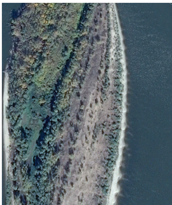
Рис. 3. Образование полос древесной растительности, способствующих осаждению взвешенных наносов (Google карты)
