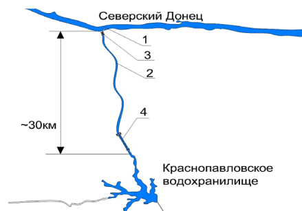
Рис. 6. Схема переброски части стока Северского Донца в Краснопавловское водохранилище посредством бокового регулируемого водозабора:
