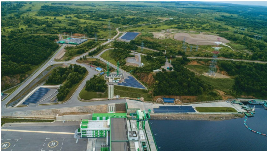
Рис. 2. Гибридная генерация гелиоустановок с использованием существующей сетевой инфраструктуры на Нижне-Бурейской ГЭС
