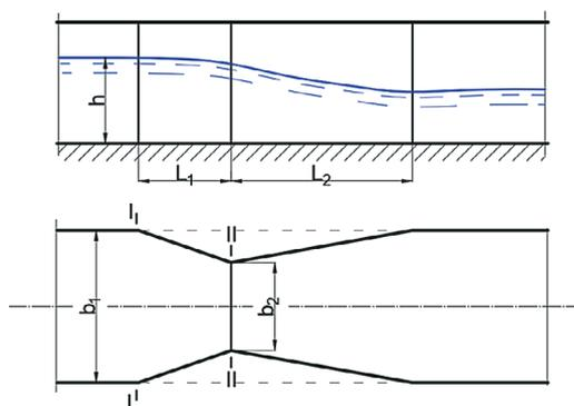
Рис. 2. Схема расходомерного лотка
