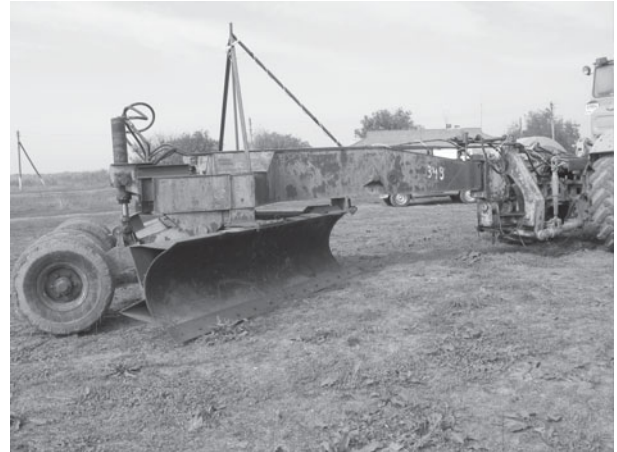
Рис. 6. Короткобазовый автоматизированный клин-планировщик КПУ-4,5
