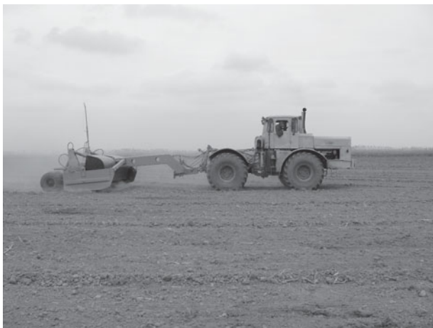
Рис. 10. Короткобазовый скрепер-планировщик СП-4,2 с аппаратурой ОКО-30
