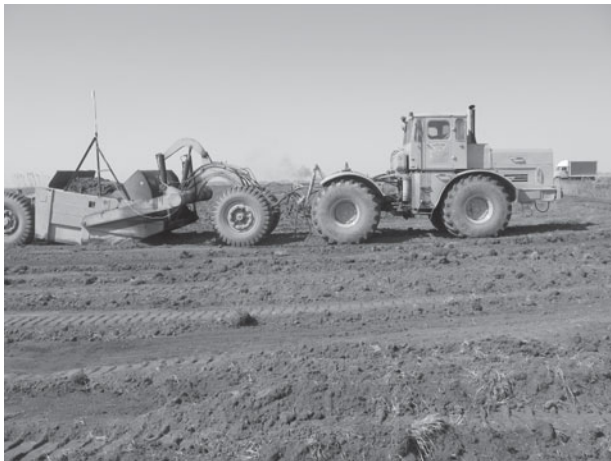
Рис. 5. Автоматизированный скрепер ДЗ-77 с лазерно-приемным устройством ОКО-30
