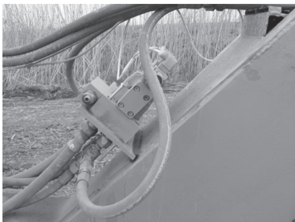
Рис. 4. Гидроблок ГБ-У, установленный спереди на раме машины (табл. 3)
