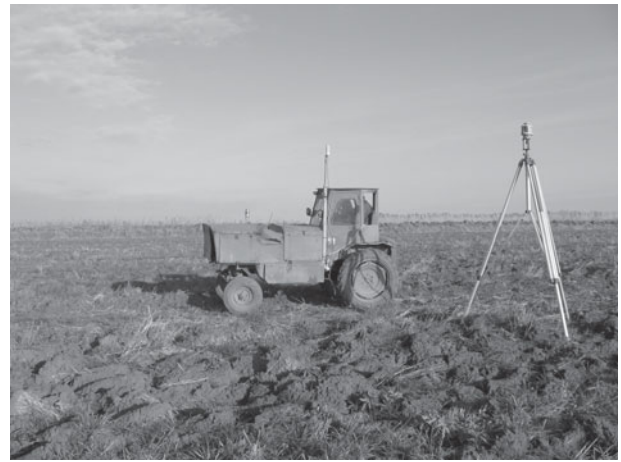
Рис. 1. Автонивелир АН-2 на самоходном шасси Т-16М с лазерным передатчиком ЛР-30АС
