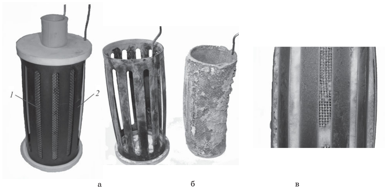
Рис. 1. Электролизная ячейка блока электрохимической очистки воды: а – электролизная ячейка в сборе (1 – катод; 2 – анод); б – электролизная ячейка после использования ее в системе комплексной водоочистки; в – электролизная ячейка после проведения переполюсовки
