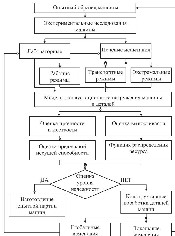
Схема оценки заданного уровня надежности деталей машины расчетно-экспериментальными методами
