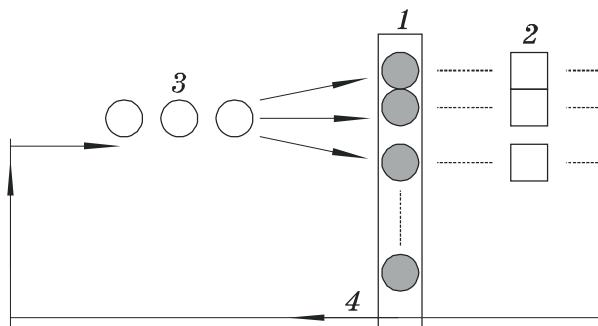
Рис. 1. Принципиальная схема системы эксплуатационного обеспечения, безотказной работы агрегатов: 1 – накопитель; 2 – приборы обслуживания; 3 – поток требований; 4 – «обслуженные» требования
