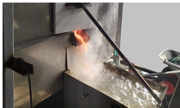
Рис. 3. Опытная установка остеклования на канализационных очистных сооружениях
