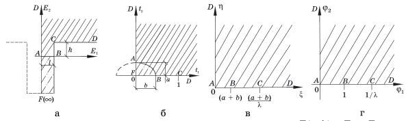
Конформное отображение четырехугольника ABCD области  $E(\varphi,\lambda) = E_1 + iE_2$  на первый квадрант области  $\varphi = \varphi_1 + i\varphi_2$ : а — четырехугольник ABCD комплексной области  $E(\varphi,\lambda) = E_1 + iE_2$ ; б — комплексная область  $t = t_1 + it_2$  с вырезанной эллиптической частью ABF; в, г — соответственно комплексные области  $\zeta = \xi + i\eta$  и  $\varphi = \varphi_1 + i\varphi_2$
