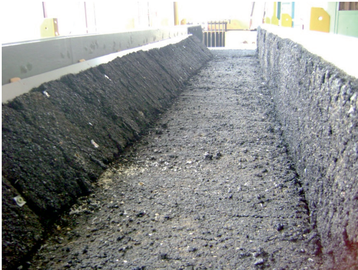
Рис. 5. Сечение исследованного лотка с уложенным геоматериалом
