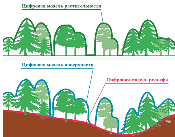
Рис. 2. Схема формирования высотной модели растительности
