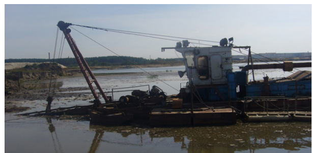
Рис. 2. Разработка донных отложений землесосным снарядом ЗРС-1600/25
