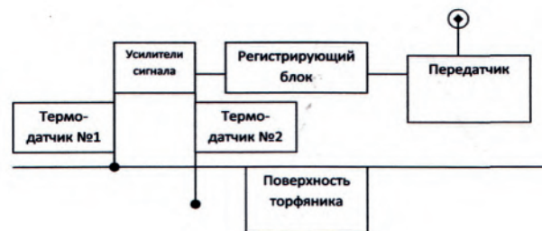
Рис. 1. Схема устройства для мониторинга за состоянием торфяника
