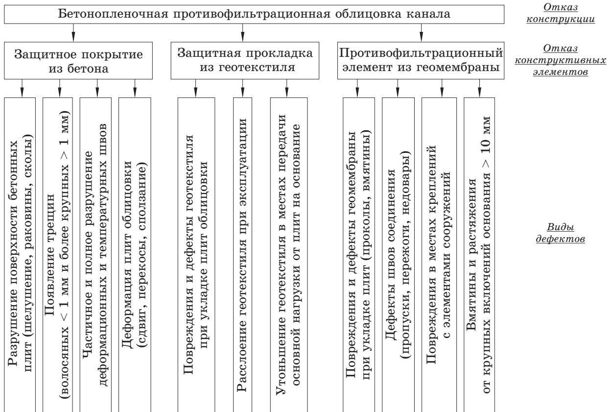
Рис. 1. Структурная схема надежности бетонопленочной облицовки с применением геомембраны
