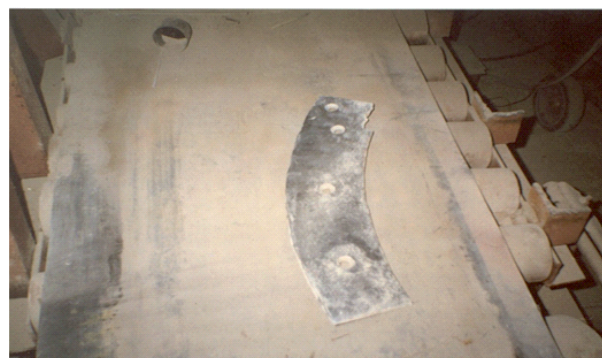
Рис. 3. Рабочая лопатка смесителя, подверженная интенсивному ударно-абразивному изнашиванию
