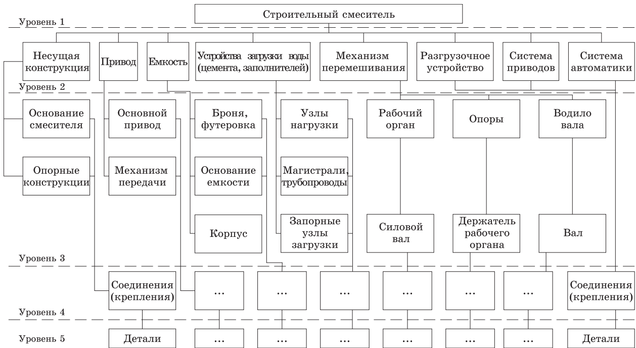
Рис. 4. Структурная схема строительного смесителя как объекта исследования
