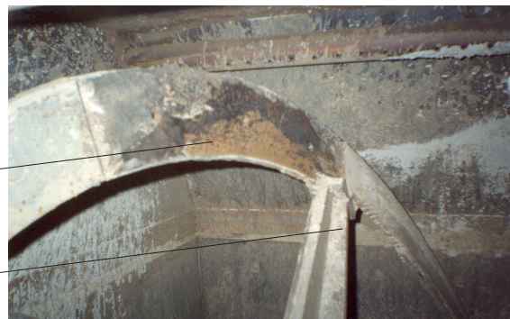
Рис. 2. Вид изношенных рабочих элементов смесителя: 1 – фрагмент рабочей лопасти
