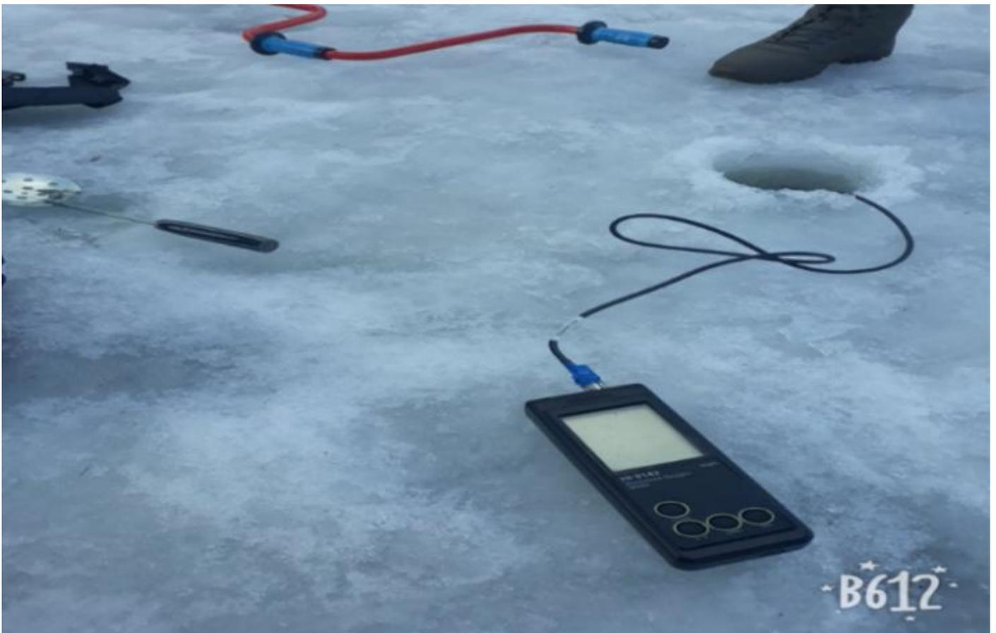
**Рис. 2. Прибор для измерения растворенного кислорода**
