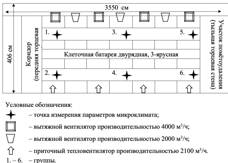
Рис. 1. Схема измерения параметров микроклимата и размещения вентиляционного оборудования (вид птичника сверху)
