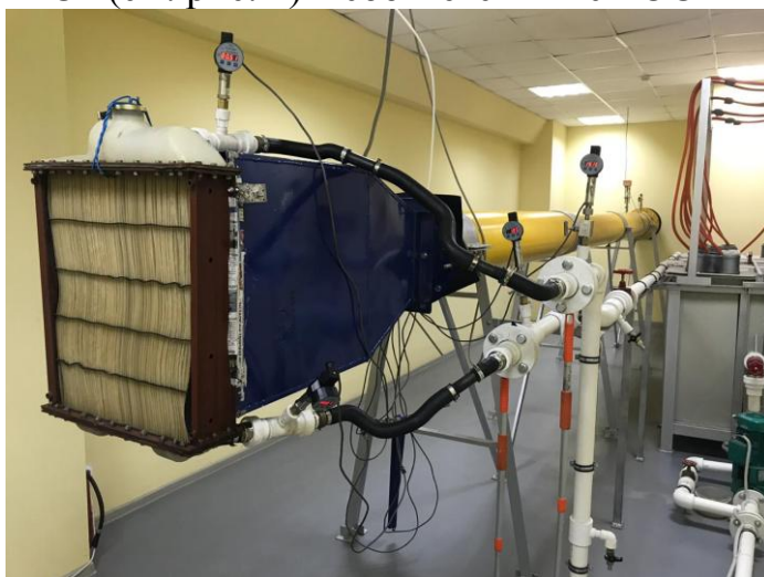
Рис. 2. Стендовые испытания опытного образца радиатора МТЗ-80 с полиуретановой сердцевиной
