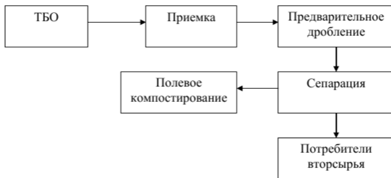
Рис. 2. Структурная схема технологии аэробного компостирования ДРО в полевых условиях, с предварительным дроблением
