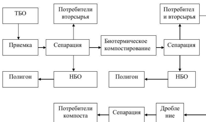
Рис. 1. Пример структурной схемы технологии аэробного компостирования ТБО в промышленных масштабах
