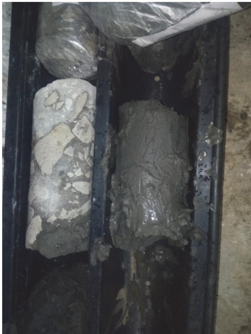
**Фото 2. Контакт бетона и грунта основания**
