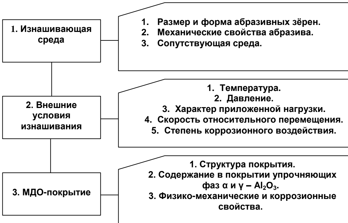
Рисунок 1 – Структурная модель сложной многоуровневой трибологической системы
