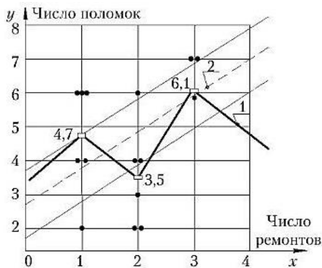
Рис. 1.25. Регрессионная зависимость числа поломок коленчатых валов от числа предшествующих ремонтов: опытная (1), теоретическая (2) составляющие
